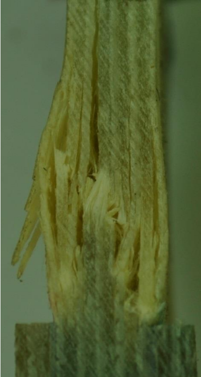
Figuur 28: Knik van lamellen en secundaire delaminatie
