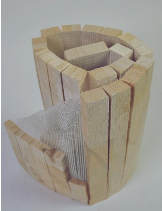
Figuur 16: Kernmateriaal met groeven (bron: WMC)
