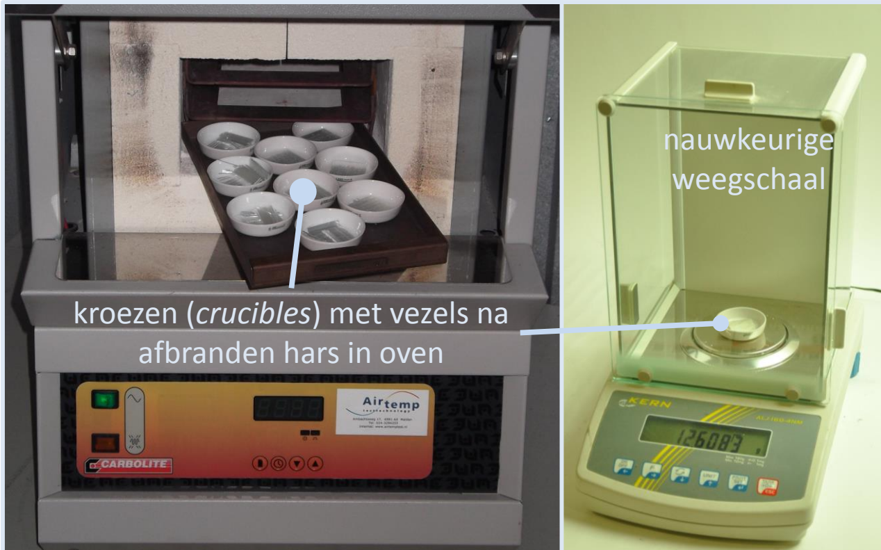
Figuur 68: Benodigdheden voor het doen van vezelvolumegelaltmeting (bron: WMC)
